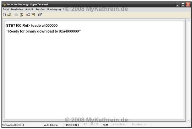
7. Im HT oben rechts "Übertragung" -> "Datei senden" wählen und dann den Pfad zu der emergency.ub angeben, "Kermit" wählen und "Senden". Es dauert etwa 9 Minuten, bis die Datei übertragen ist; am PC sieht man der Verlauf.
