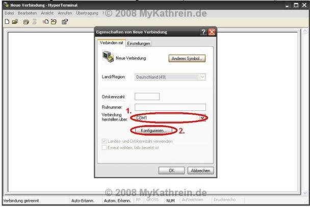
3b. Danach auf "Konfigurieren" -> "Bits pro Sekunde:"115200, "Datenbits:" 8, "Parität:" Keine, "Stoppbits:" 1, "Flusssteuerung:" Kein; dann "Übernehmen", "OK", "OK"
