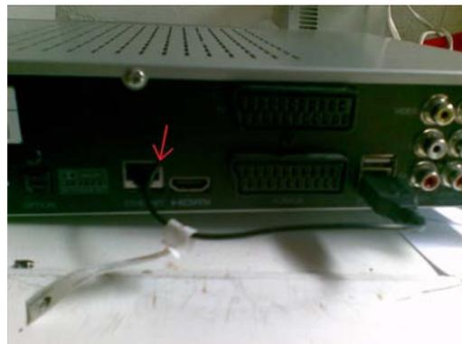
3. Vom USB Anschluss bekommt man 5V somit läuft der Lüfter ziemlich leise und man hat keine Eingriffe auf der Platine, der Garantie wegen. Anschliessend habe ich das Kabel an die Leitung des Lüfters Gelötet und den Lüfter mit einer Heissklebepistole an der Gehäusedecke angeklebt. Man muss ihn so Positionieren, dass er nirgendwo schleifen kann.
