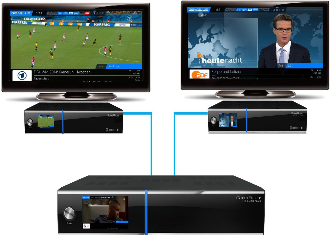
Alle Fernseh- und Radioprogramme werden von der GigaBlue Server-Betrieb über das Heimnetzwerk an die Clients verteilt (per TS over UDP, IPv6), selbst HDTV und Pay TV (auch zeitgleich von unterschiedlichen Transpondern\*) sind in jedem Raum verfügbar, sowohl für die als MultiRoom-Server agierende GigaBlue als auch für die NetClients in den verschiedenen Zonen.
